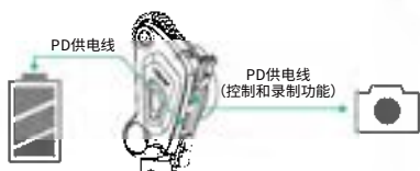
PD电源/V口电池+1个电机+PD供电线 (Type-C to C)+相机
